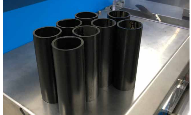
Durch die verstärkte Konstruktion von Maschinenrahmen, Messerbalken und -halterung sowie Servomotor können auch größere und dickere Kunststoffrohre geschnitten werden.
